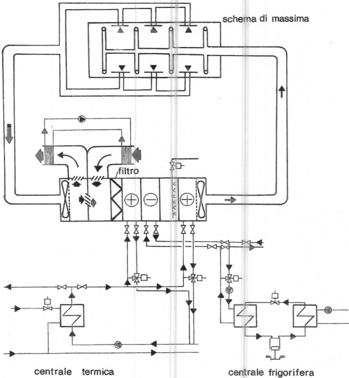
*Ciclo estivo ed invernale con regolazione tramite termostati e valvole motorizzate.*
